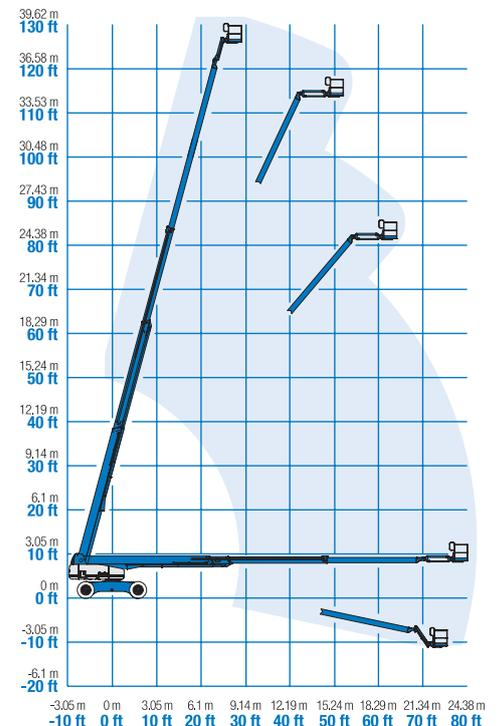
\* En el sistema métrico, altura de trabajo = altura de la plataforma + 2 m.
